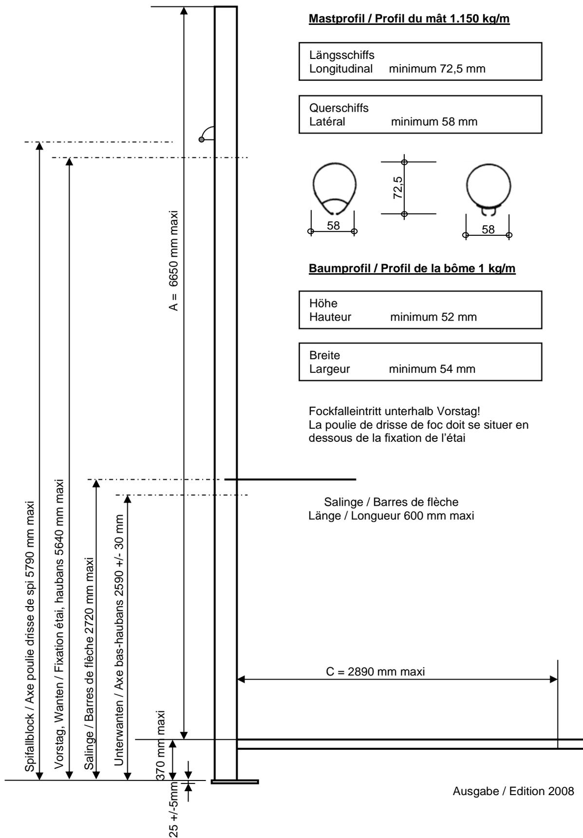
**Mastprofil / Profil du mât 1.150 kg/m**
